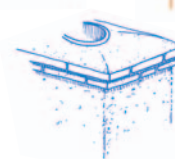
Deux rangées de petites briques sur la maçonnerie de moellons enduite
